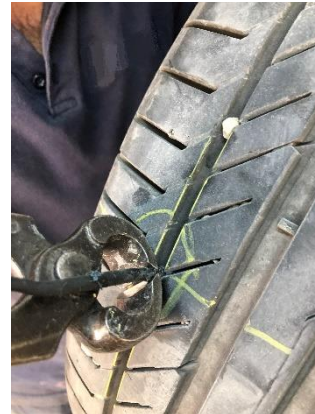
Mantar yamanın dışarıda kalan uzantısının kesilmesi
