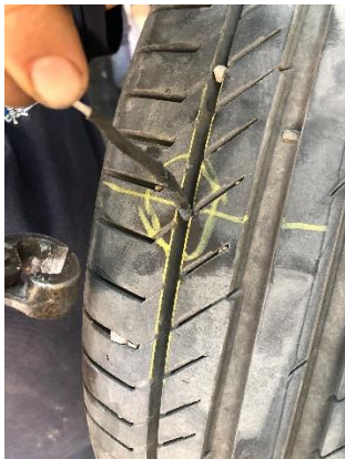
Mantar yamanın dışarıda kalan uzantısının kesilmesi
