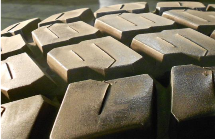
Foto3: Blok desenli çeker aks lastiğinde oluşan tüylenecek aşınma
