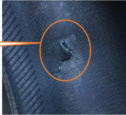
Astarda kırılma izi
