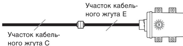
При использовании дополнительного приемника можно смонтировать участок кабельного жгута Е между участком жгута проводов D и центральным блоком управления (CCU) (см. иллюстрацию ниже) **или** участки кабельных жгутов С и D.
