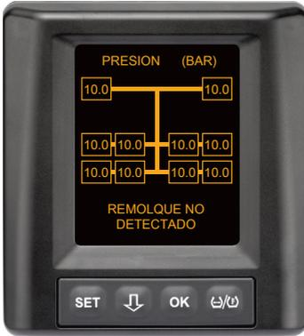
Se reciben datos de los neumáticos de todas las ruedas del camión y la programación automática del remolque (ATL) ha concluido, pero no se ha encontrado ningún remolque con sensores de neumático.
