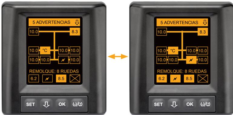
5 mensajes de alerta diferentes para los neumáticos del camión y el remolque.
