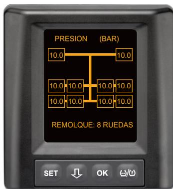
Esta indicación aparece si no se cumplen las condiciones para la programación automática del remolque con posición del neumático y los valores de la presión de inflado y de la temperatura dentro del neumático están dentro del rango de valores permitidos.
