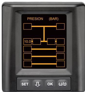
Se reciben datos sobre el neumático de la rueda exterior izquierda del 2.º eje.
