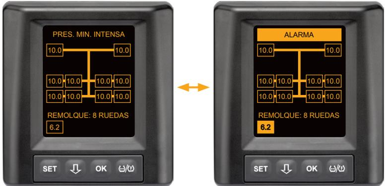
Existe un problema en 1 neumático de los 8 que tiene el remolque.
