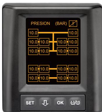
Las advertencias desactivadas aparecen permanentemente en la pantalla durante el funcionamiento por medio de un signo de exclamación tachado en la esquina superior derecha.
