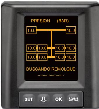
Se reciben datos de los neumáticos de todas las ruedas del camión y la programación automática del remolque (ATL) todavía no ha concluido.
