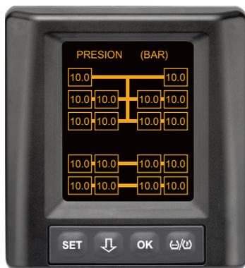
Esta pantalla aparece cuando se cumplen las condiciones para la programación automática del remolque con posición del neumático. Los valores de los neumáticos del remolque se muestran individualmente con la posición. Su visualización corresponde a los neumáticos de los camiones.
