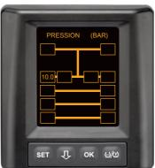
Des données de pneus sont reçues pour la position du 2e essieu extérieur gauche.
