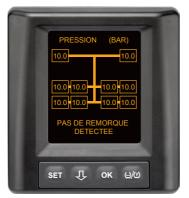
Des données de pneus sont reçues pour toutes les positions de pneus des camions et la détection automatique de remorque (ATL) est terminée, mais aucune remorque n'a été trouvée avec des capteurs de pneus.
