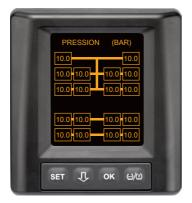
Cet affichage apparaît lorsque les conditions pour la détection automatique de remorque avec position des pneus sont remplies. Les valeurs des pneus de la remorque sont affichées individuellement avec la position. Leur représentation est semblable à celle des pneus du camion.
