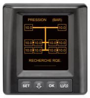
Des données de pneus sont reçues pour toutes les positions de pneus des camions et la détection automatique de remorque (ATL) n'est pas encore terminée.
