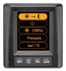
Appuyer sur la touche OK pour passer du mode Jour au mode Nuit et inversement. Le changement dépend du dernier réglage. L'écran repasse à l'aperçu du véhicule.
