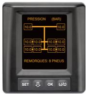
Cet affichage apparaît lorsque les conditions pour la détection automatique de remorque avec position des pneus **ne sont pas** remplies et que les valeurs pour la pression de gonflage et les températures à l'intérieur des pneus reposent dans la plage de valeurs autorisée.
