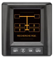
Le système CPC est prêt à fonctionner. Les données de pneus sont affichées progressivement au plus tard une fois le trajet commencé. La détection automatique de remorque (ATL) n'est pas encore terminée.
