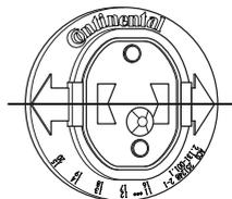
El montaje defectuoso provoca un daño del sensor de neumático durante el funcionamiento. En ese caso el sistema avisa „**COMPROBAR SENSOR / DESMONTAJE NEUMÁTICOS**“.
