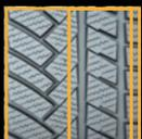
**Kürzere Bremswege durch ActiveBand, einer unterbrochenen Bandstruktur.**
