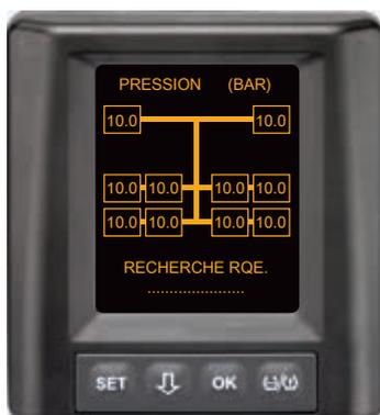
Des données de pneus sont reçues pour toutes les positions de pneus du camion et la détection automatique de remorque (ATL) n'est pas encore terminée.
