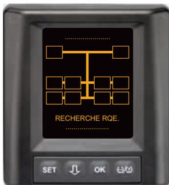
Le système CPC est prêt à fonctionner. Les données de pneus sont affichées progressivement au plus tard une fois le trajet commencé. La détection automatique de remorque (ATL) n'est pas encore terminée.
