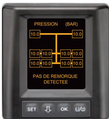
Des données de pneus sont reçues pour toutes les positions de pneus du camion et la détection automatique de remorque (ATL) est terminée, mais aucune remorque n'a été trouvée avec des capteurs de pneus.
