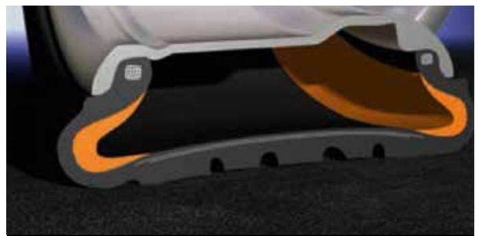
Lorsqu'une crevaison se produit avec un pneu standard, le flanc peut s'écraser entre la jante et la route, ce qui peut être dangereux. Le flanc renforcé du pneu à roulage à plat autoportant empêche que cela ne se produise.
