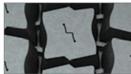
**La technologie innovante et brevetée** des rainures mène à une rétention minimale des pierres et à un allongement de la durée de vie de la carcasse.
