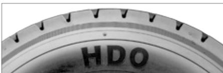
**Profonde bande de roulement de 32/32<sup>®</sup> résistante** aux coupures et fissures, ce qui offre une excellente traction dans des conditions tout terrain.
