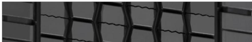
Les caractéristiques de profondeur de la bande de roulement de 27/32" sont **une sculpture innovante des lamelles** et des épaules fermées.
