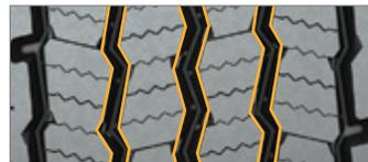
La géométrie des rainures de la bande de roulement **minimise la rétention des pierres** tandis que les blocs rigides de la bande de roulement offrent une excellente résistance à l'usure.
