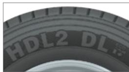
Les caractéristiques de profondeur de la bande de roulement de 32/32" offrent un millage élevé et un faible coût par mille.
