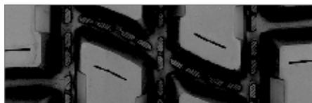
**La technologie innovante et brevetée des rainures** mène à une rétention minimale des pierres et à un allongement de la durée de vie de la carcasse.
