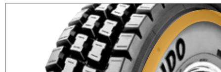
Le profil du flanc avec nervures réduit les dommages engendrés par les trottoirs, les coupures et l'abrasion.
