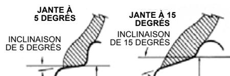
Le diagramme suivant indique comment les talons d'un pneu de 16" ne peuvent être installés sur une jante de 16,5". Les talons ne peuvent pas être poussés de force contre les rebords de la jante par la pression de l'air, car cet effet brisera les talons et le pneu explosera avec une force suffisante qui risque de causer de graves blessures ou la mort.
