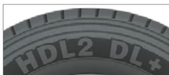
La **profondeur de la bande de roulement de 32/32 po (25,40 mm)** assure un kilométrage élevé et un faible coût par kilomètre.
