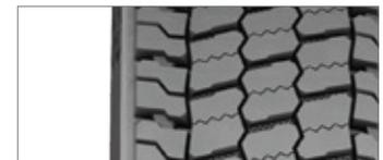
Modèle de bande de roulement 16/32 po conçu pour offrir un **kilométrage et des performances** de maniabilité améliorés.
