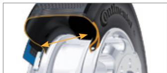
**La répartition optimisée de la pression** sur la largeur de l'empreinte offre un kilométrage exceptionnel et une usure uniforme.
