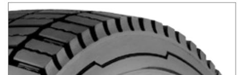
**L'épaulement chanfreiné** réduit l'amplitude de déformations des zones de flancs et de talon, ce qui entraîne une amélioration de la résistance au roulement et donc une diminution de la consommation de carburant.
