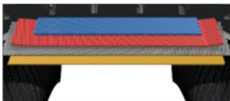
L'augmentation de la rigidité dans **les ceintures** offre une usure homogène et uniforme.
