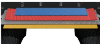
**Ceinture et bande de roulement améliorées** pour un meilleur kilométrage et une meilleure résistance aux coupures et aux déchirures.
