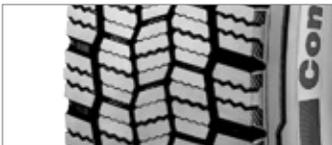
**Bande de roulement profonde avec réduction de l'espacement** pour garantir un millage élevé.
