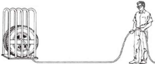
UNE EXPLOSION DU PNEU ET DE LA JANTE À CAUSE D'UN MONTAGE MAL FAIT - UTILISEZ UNE CAGE DE SÉCURITÉ ET UNE RALLONGE DE TUYAU D'AIR. SEULES LES PERSONNES SPÉCIALEMENT FORMÉES DEVRAIENT INSTALLER DES PNEUS.
