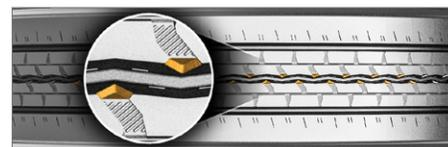
**Le système d'éjection de pierres de forme pyramidale** est intégré dans la rainure centrale pour une protection supplémentaire de la carcasse.
