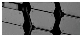
**La technologie innovante et brevetée des rainures** mène à une rétention minimale des pierres et à un allongement de la durée de vie de la carcasse.
