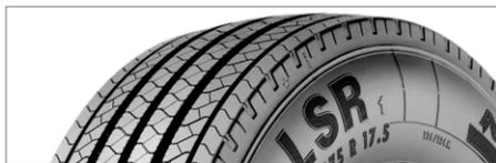
**La sculpture avec nervures multiples de la bande de roulement** offre une excellente traction sur sol mouillé, une stabilité latérale et fait peu de bruit.
