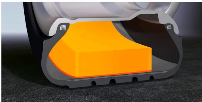
Eine spezielle Schicht Polyurethanschaum wird auf der Innenseite der Reifenlauffläche angebracht, um die **Hohlraumgeräusche im Reifeninneren zu dämpfen** und zu verhindern, dass sie über die Karosserie übertragen werden.
