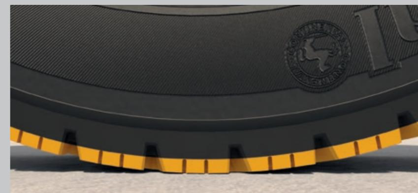
Das Zweiphasenprofil von Continental ist, als ob zwei Reifen in einem integriert wären. Die Profilstruktur ändert sich von einer offeneren Struktur für eine sicherere Haftung zu einem geschlossenen Profil, das für einen geringen Rollwiderstand mit ebenso guter Haftung auf der Fahrbahnoberfläche optimiert ist. Wenn das Winterprofil abgenutzt ist, verbleibt ein Reifen für Lenk- und Trailerachsen mit sehr guten Verbrauchswerten für die Sommersaison.
