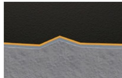
Auf winterlichen Straßen geht es nicht nur um die Vermeidung von Makroschlupf (Durchdrehen der Reifen), sondern auch von Mikroschlupf, d. h. dem Rutschen einzelner Blöcke. Die Gummimischungen von Continental minimieren diesen Effekt, da sie den Reifen hochflexibel und haftfähig halten und gleichzeitig für eine hohe Verschleißfestigkeit sorgen.
