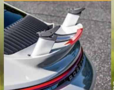
Im ersten Versuch schaffte der 9FF Turbo nur 345,7 km/h. Durch den Abbau des Heckleitwerks war man noch mal 8 km/h schneller
