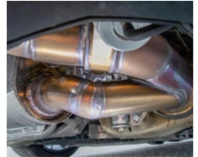
Zum „kleinen“ Stage-2-Kit zählt auch die Integrierung von 200-Zellen-Metall-Motorsportkatalysatoren
