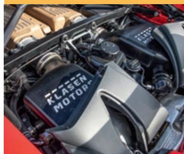
Klasen-System: Das Wasser der Ladeluftkühlung kann über einen zusätzlichen Wärmetauscher von der Klimaanlage abgekühlt werden
