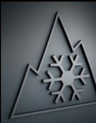
Continental recomienda el uso de neumáticos con el símbolo del copo de nieve en el flanco y una profundidad de banda de rodadura mínima de 4 mm en invierno. El símbolo identifica los neumáticos de invierno con arreglo al estándar del sector de neumáticos, basado en una definición americana de neumático de invierno. Estos neumáticos ofrecen altas prestaciones de seguridad y control sobre nieve, en carreteras heladas y, en general, a bajas temperaturas.
