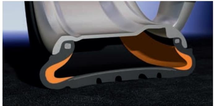
Un flanco reforzado ofrece una fortaleza adicional, evitando que la pared lateral se aplaste entre la llanta y la carretera en caso de daño del neumático.
