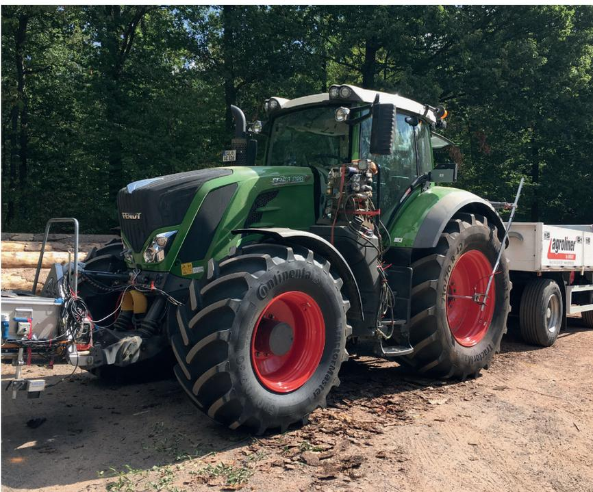
Figure 8 : Essai de conduite de DLG pour déterminer le rendement énergétique sur route
