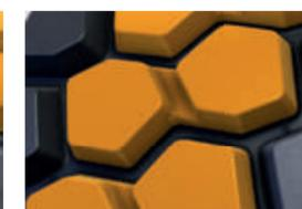
Connexion entre les pavés centraux pour une capacité de traction améliorée et un roulage confortable.
