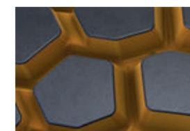
Pavés de gomme pourvus de nombreuses arêtes d'attaque pour une traction puissante sur terrain meuble.
