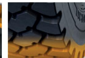
Bande de roulement avec une surface de contact au sol large et plate pour une traction optimisée.
