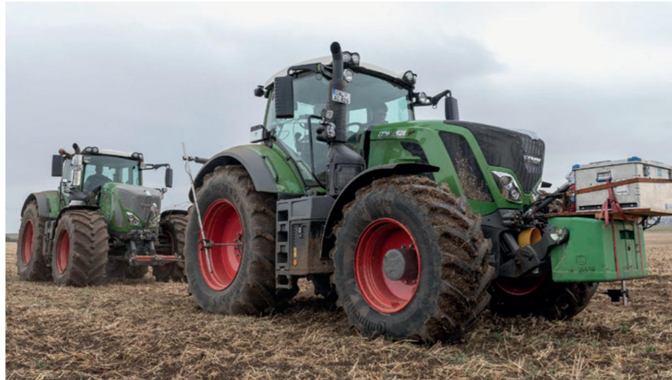
På bilden ovan visas hur däcken effektivitet fastställs i fält. Mellan dragtraktorn och bromstraktorn mäts dragkraften och slirning;bränsleförbrukning jämförs mellan olika fabrikat.
