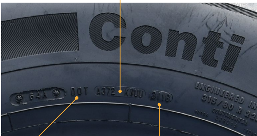
Pneu neuf - Numéro du DOT
