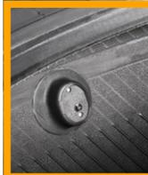
Lecture en temps réel précis de la pression et de la température des pneus • Le capteur est assorti d'une garantie de 5 ans pour minimiser les perturbations de l'exploitation. Voir la garantie pour tous les détails. • Le capteur fournit une température réelle de la carcasse permettant des actions préventives qui prolongent la durée de vie de votre pneu • Évitez les dommages aux valves et les fuites d'air grâce à un capteur collé à l'intérieur du pneu
