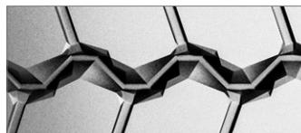
Rétention minimale des pierres grâce à la sculpture autonettoyante et à la géométrie des rainures pour une meilleure aptitude au rechapage.
