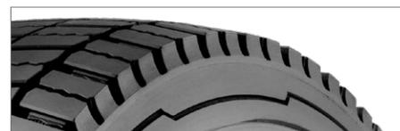
**L'épaulement chanfreiné** réduit l'amplitude de déformations des zones de flancs et de talon, ce qui entraîne une amélioration de la résistance au roulement et donc une diminution de la consommation de carburant.
