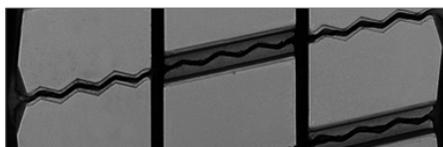
**Les fines largeurs de rainures** résultent en un volume de profil augmenté, ce qui améliore la résistance à l'usure et garantit des performances kilométriques élevées.
