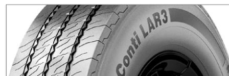
**Carcasse entièrement en acier de 10 plies pour camion léger** qui offre une capacité de charge plus importante, une durabilité et une résistance à la crevaison.
