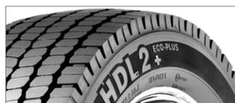
**La sculpture des épaules fermées** offre une usure égale de la bande de roulement tout en fournissant une excellente traction. Profondeur de bande de roulement de 24/32" pour un kilométrage et une résistance au roulement optimisés.
