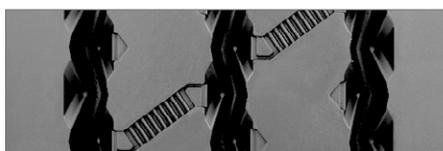
**La géométrie innovante des rainures** a été conçue pour éviter la rétention des pierres et les perforations.
