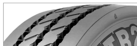
**Large bande de roulement et nervures des épaules** pour une amélioration de l'usure et une meilleure résistance aux éraflures.
